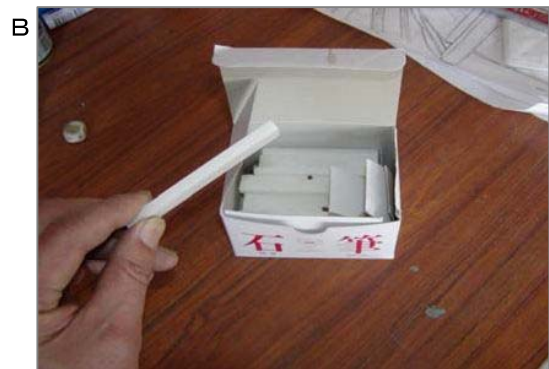
B 滑石類似の「ろう石」。石筆の原料は滑石やろう石で、これらにタルクが不純物として入っていることがあります。工事屋さんがマーキングする時などに使用していますが、全体的に粉っぽい作業です。
