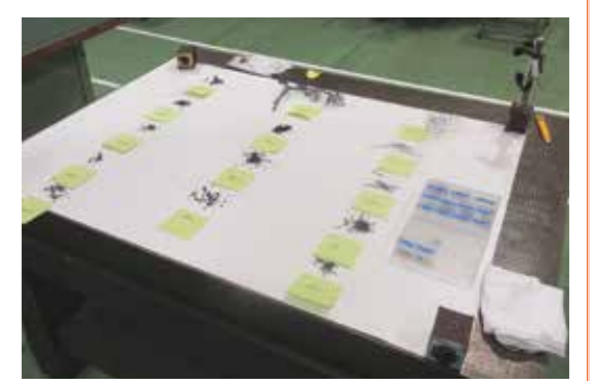
▲実習の様子「切削条件による切りくずの違い」
