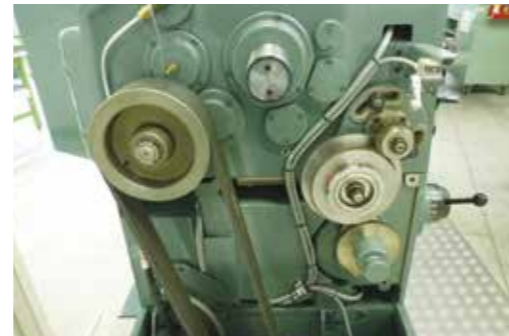
▲普通旋盤の構造(機械要素)
