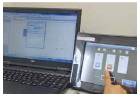
▲作成プログラムによるタッチパネル動作テスト
