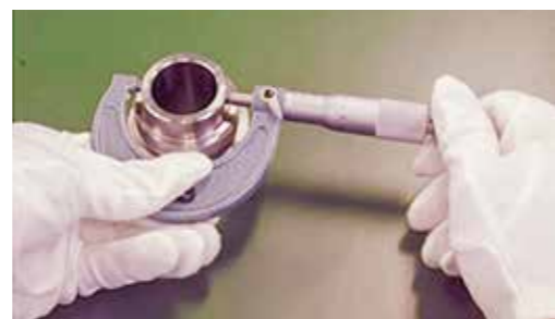
▲マイクロメータを用いた加工部品の外径測定
